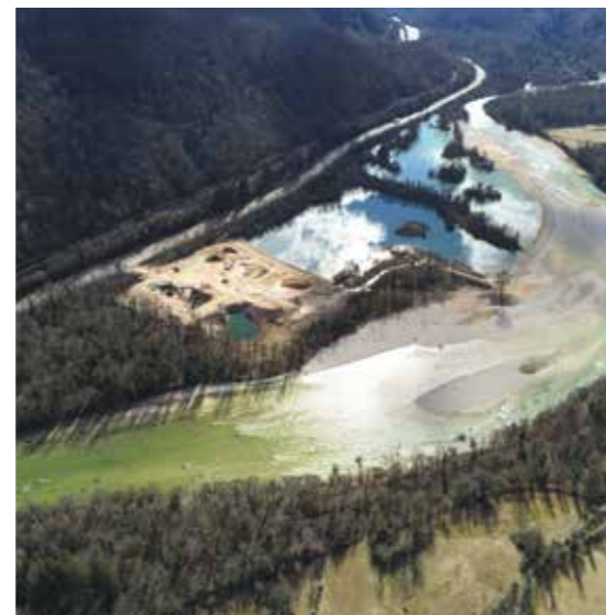
La Bienne, rivière du massif du Jura, a retrouvé sa liberté de couler avec un lit élargi de 30 à 100 m.
