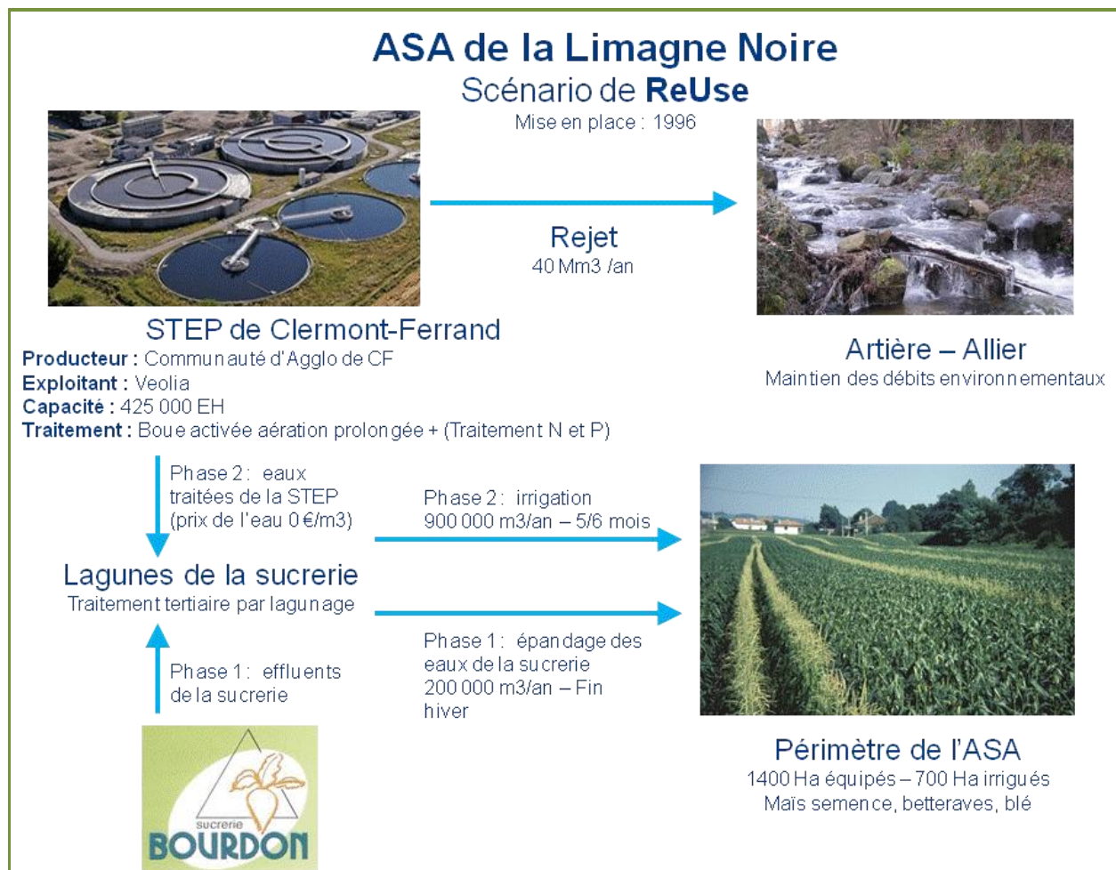
Figure 3: Représentation schématique du fonctionnement du système dans la situation avec projet de REUSE (ASA de la Limagne Noire)
