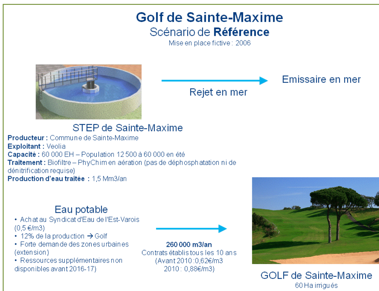
Figure 12: Représentation schématique du fonctionnement du système dans la situation de référence (Sainte-Maxime)
