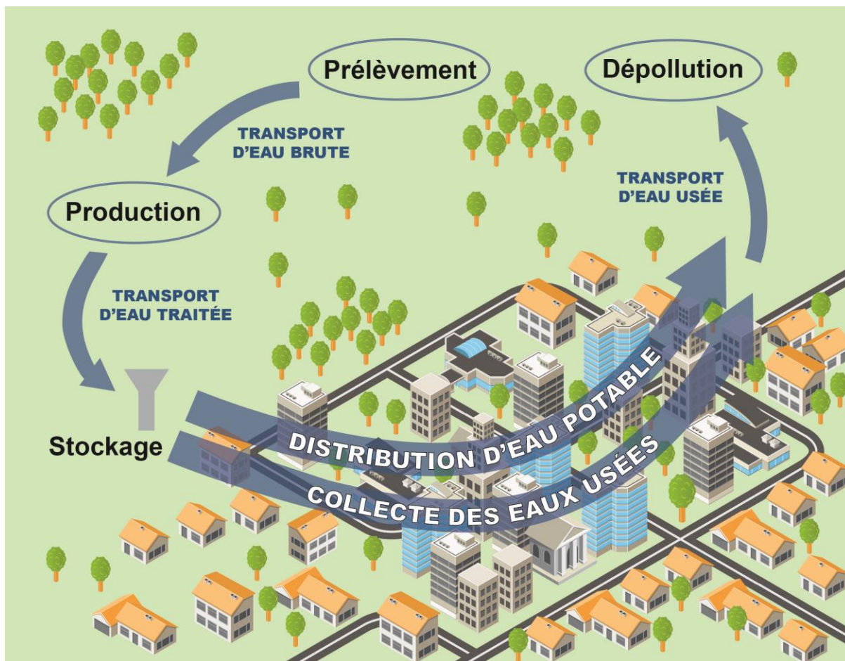
Figure 11 : Schéma des compétences et missions des collectivités en charge de l'eau potable et de l'assainissement collectif
