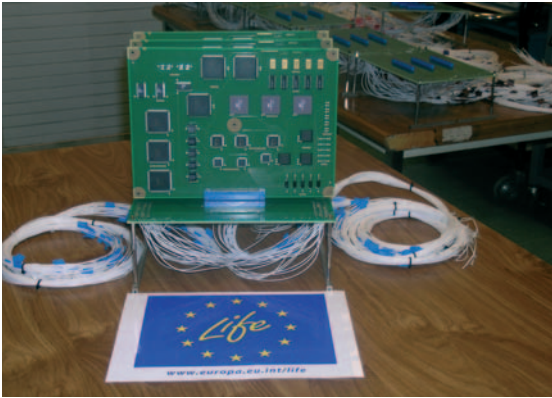
Carte de test à la sortie du four
