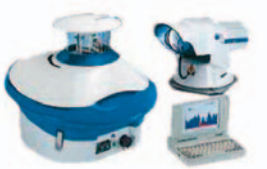
Matériel DOAS mis en place pour la mesure intégrée de pollution (photo Air Normand)
