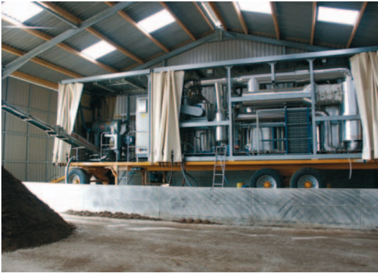
Unité de traitement de lisier mobile de 100 m 3 /jour en opération en Bretagne
